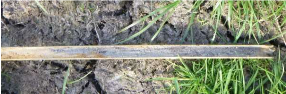
Figuur 4: Foto van het grove zand dat onderin veruit de meeste boringen is aangetroffen (rechts) met daarboven sterk zandige klei (links)
