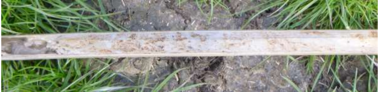
Figuur 5: Foto van boring 24 met daarin de vegetatie-horizont. Hierin zijn opgevulde graafgangen te zien als donkere vlekjes.
