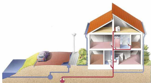
Figuur 6b: uitleg werking (vrijval) rioolstelsel – gescheiden riool
